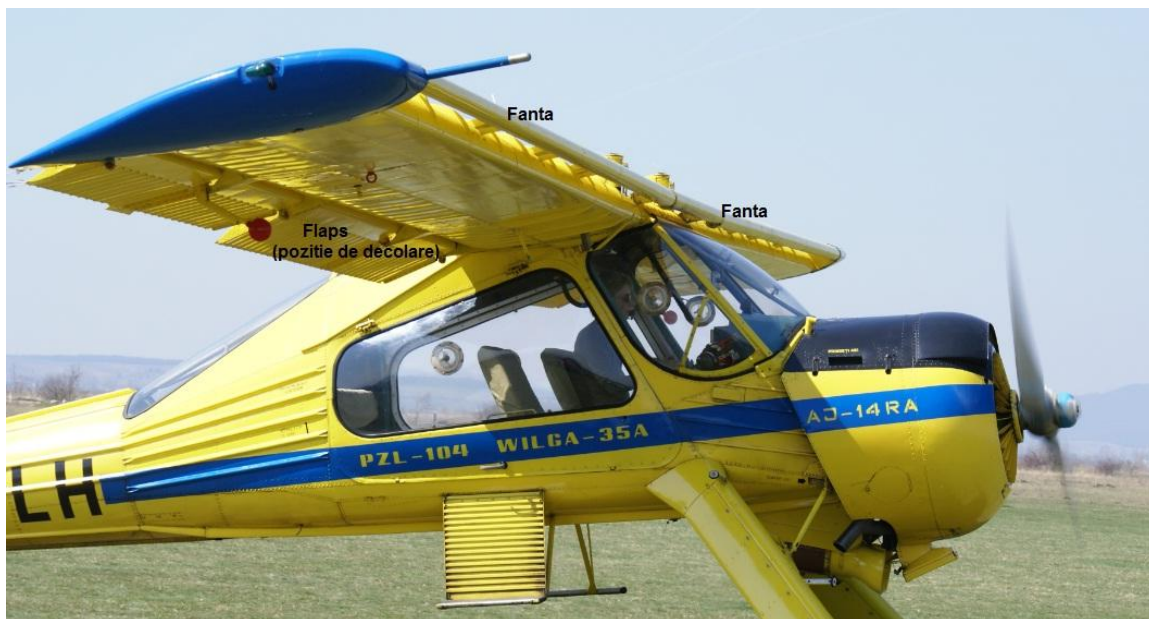
Fig. 1.28 Bracajul flapsului pentru decolare
