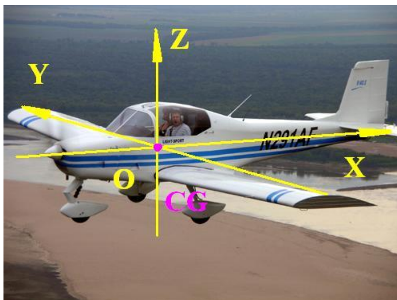
Fig. 1.26. Cele trei axe ale unei aeronave
