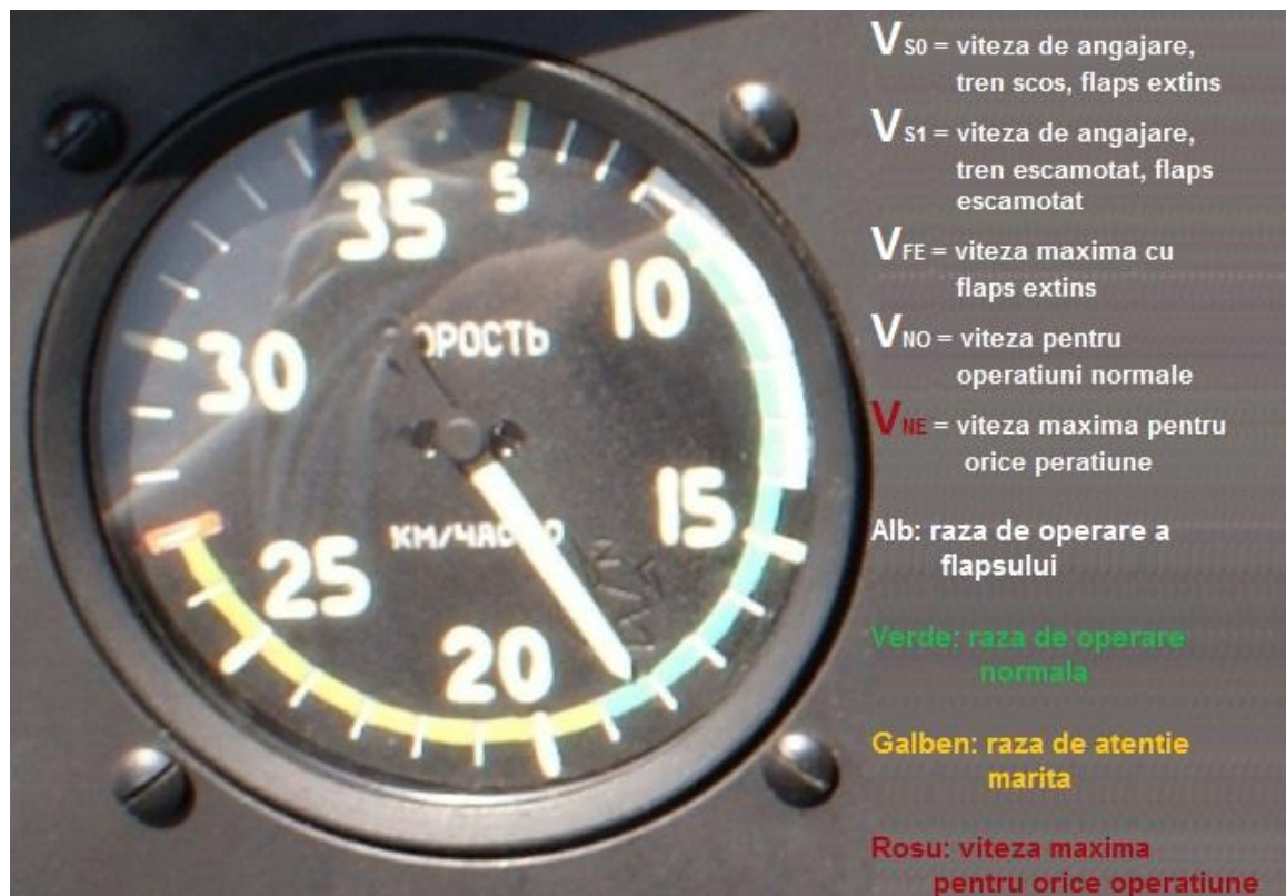
Fig. 4.8. Marcarea în culori a vitezometrului
