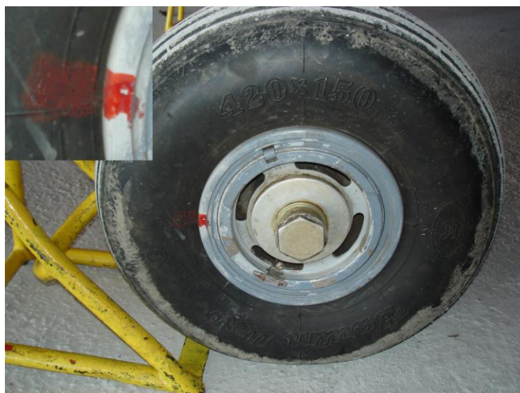
Fig. 1.43. Semne pe flansa rotii – Zlin 526F
