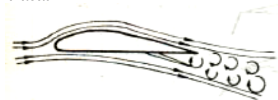
Fig 2.21. Spectrul aerodinamic in cazul voletului bracad
