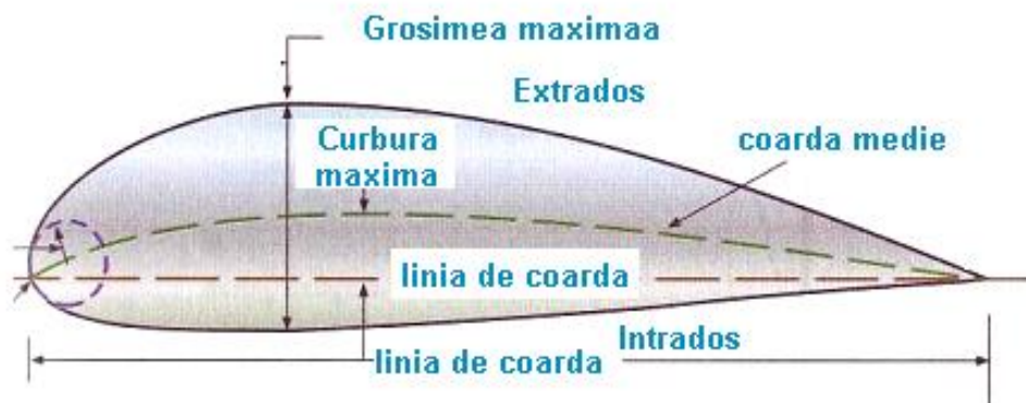
Fig 3.17. O aripa tipica de viteza redusa, bine curbata
